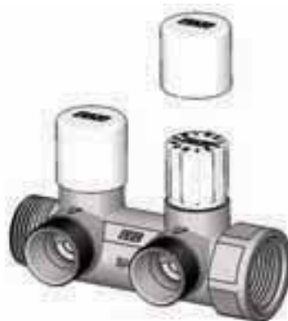
Рис. 12. Установка защитного колпачка
