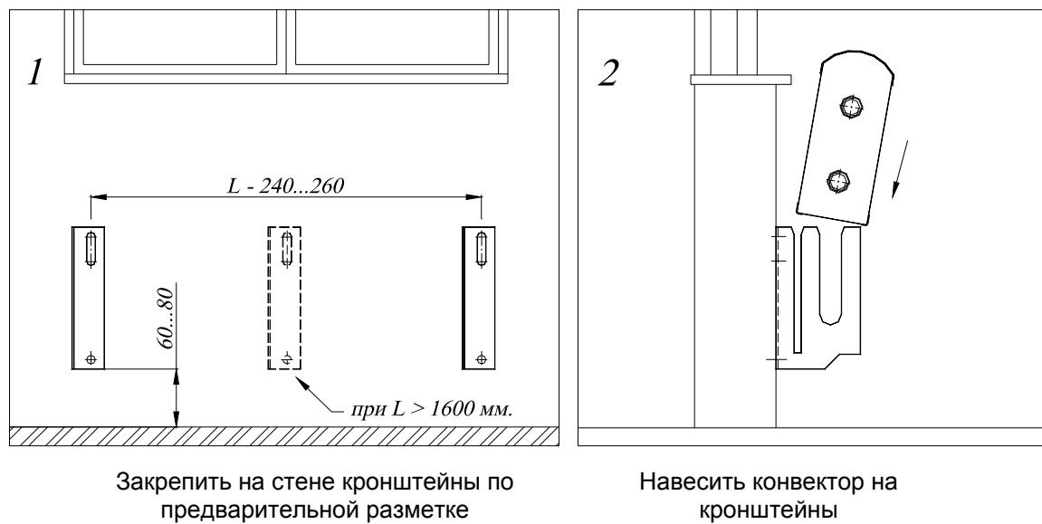
Рис. 5.1. Порядок установки настенных конвекторов
