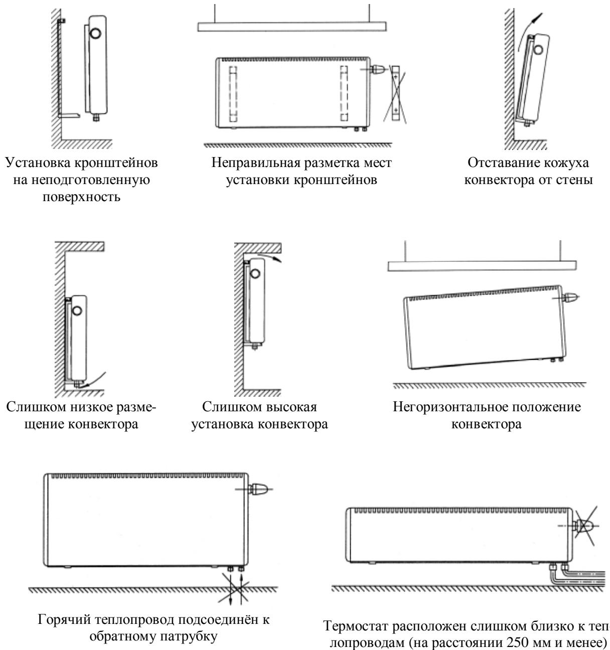
Рис. 6.2. Случаи неправильной установки конвекторов «Экотерм»
