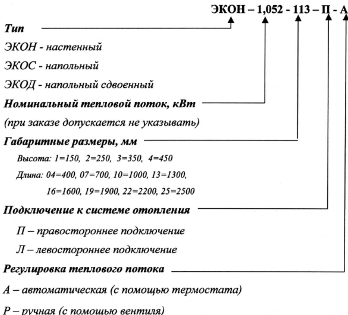
Согласно указанной схеме ниже приведены примеры условного обозначения конвекторов «Экотерм», принятого заводом-изготовителем при поставке конвекторов в Российскую Федерацию (при заказе и в документации другой продукции, в которой они могут быть применены).
