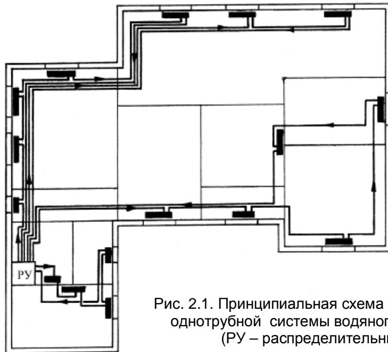
Рис. 2.1. Принципиальная схема поквартирной однотрубной системы водяного отопления
