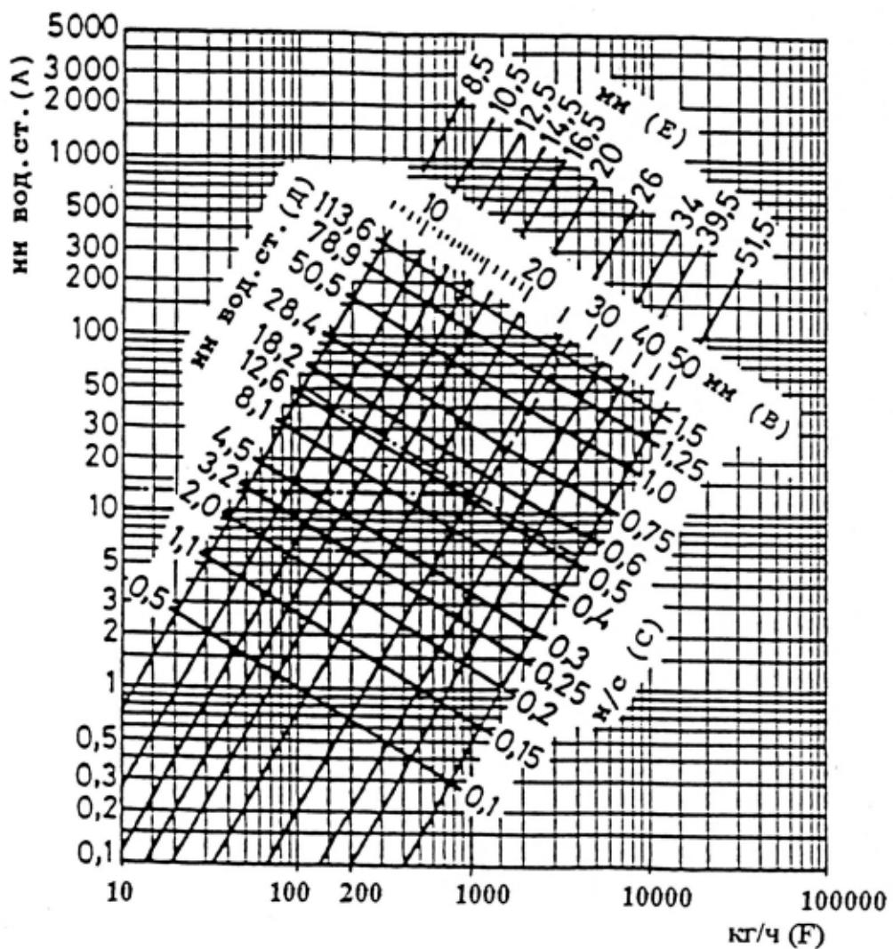
**A** – потери давления на трение в медных трубах 1 м при температуре теплоносителя 40°C, мм вод. ст.;
